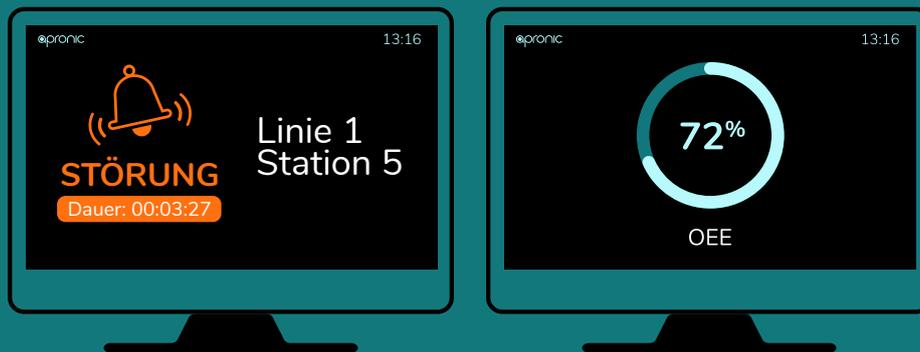
**Andon** ist eine Methode des visuellen Datenmanagements, stammt aus Japan und wurde als Teil des Toyota-Produktionssystems entwickelt. Andon-Systeme visualisieren Betriebszustände von Produktionslinien oder einzelnen Maschinen. Die Informationen sollen für alle Personen verständlich und sofort erkennbar angezeigt werden.
